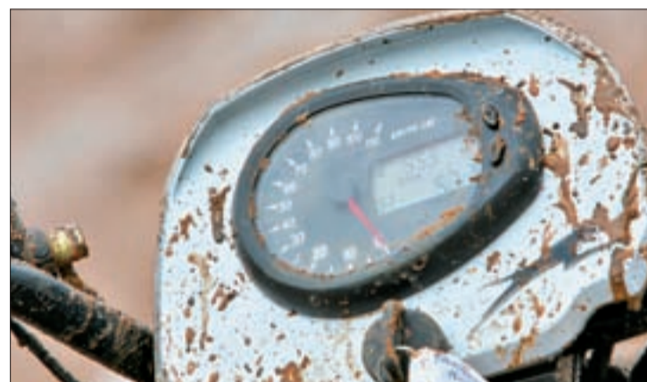
Панель приборов с аналоговым спидометром. На ЖК-монитор выводится информация о суточном и общем пробеге, наработке мотора в часах, текущем времени, уровне топлива и режиме работы трансмиссии. В общей сложности «приборка» имеет 14 индикаторов.
