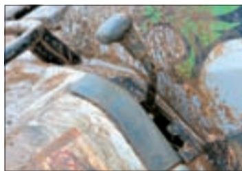
ATV оборудован системой блокировки дифференциала. Есть и такая полезная функция, как «reverse override».
