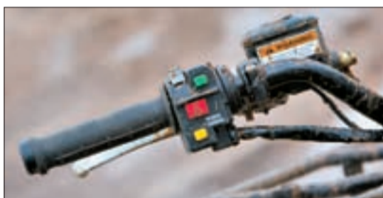
ATV оборудован системой блокировки дифференциала. Есть и такая полезная функция, как «reverse override».
