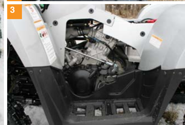
3 До элементов двигателя и трансмиссии Thundercat легко добраться благодаря съемным боковым кожухам
