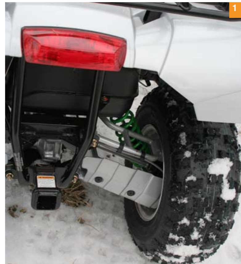
1 Фаркоп крепится к раме в том месте, где она наиболее прочна, и здесь же крепится редуктор, увеличивая ее жесткость
